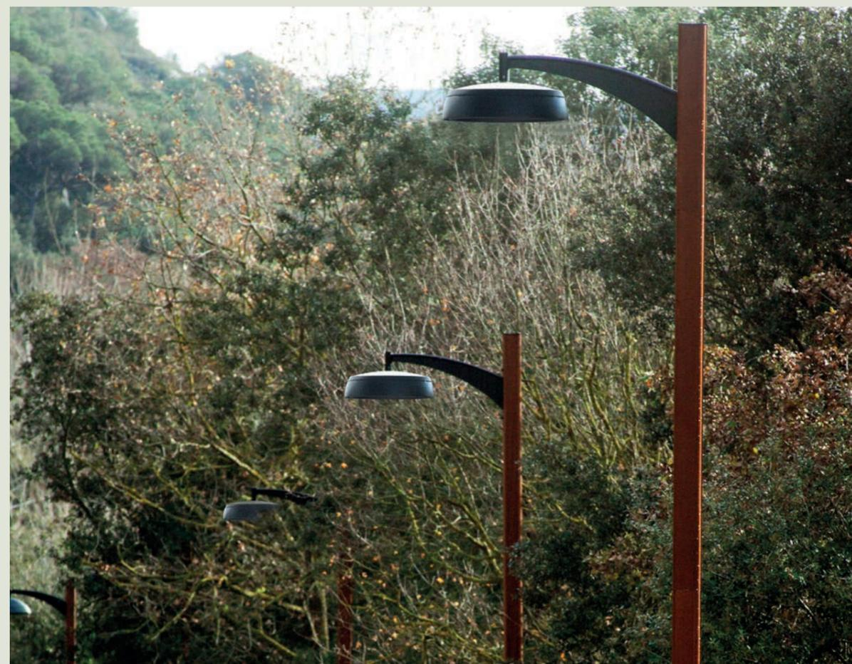
Palo con base e braccio in acciaio con finitura zincata e rivestito con uno strato di primer epossidico e uno di verniciatura al poliestere, entrambi polverizzati elettrostaticamente e sublimati in forno, colore nero forgia e fusto in laminato di legno di pino scandinavo con trattamento in autoclave di Classe IV.
