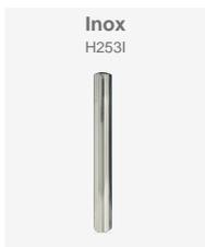
Dissuasore realizzato in acciaio inossidabile AISI-304 con finitura lucida. Ancoraggio raccomandato: mediante base di alloggiamento da ancorare in CLS, realizzata in acciaio zincato, munita di copertina di chiusura.
