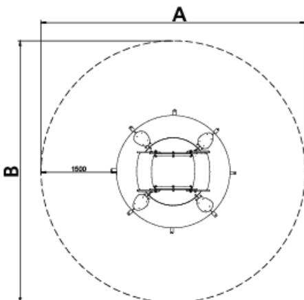
**Structure, Metal:** Poteaux Ø35mm AISI-304 acier inoxydable.. La surface de glissement est de 2 mm d'épaisseur AISI304 acier inoxydable poli et est incurvée et moulé en une seule pièce.
