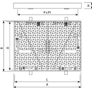
Comunicación, für mittelmäßigen Verkehr geeignet. Ideal für einen durchschnittlichen täglichen Verkehr von 1.000 bis 20.000, Fahrbahnen, Fußgängerzonen, Seitenstreifen, und Parkplätze für alle Fahrzeugarten. Kugelgraphit Duktillguss, gemäß IS 1083 (Typ 500-7) und Norm EN 1563. Verschluss durch Eigengewicht Mit Dichtung zur Schalldämmung Rutschfeste Oberfläche. Mit ungiftiger, umweltverträglicher und feuerfester Farbe in schwarz.
