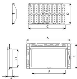
Duna D4 está diseñada para soportar un tráfico intenso. Perfecta para instalar en vías con una IMD de 1.000-20.000, especialmente calzadas de carreteras (incluyendo calles peatonales), arcenes estabilizados y zonas de aparcamiento para todo tipo de vehículos.
