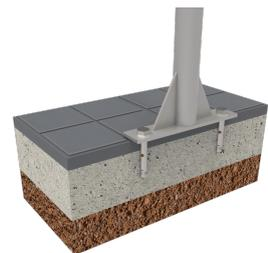
Cubeta de acero galvanizada reforzada, con tratamiento Ferrus, proceso protector del hierro que garantiza una óptima resistencia a la corrosión. Imprimación epoxi y pintura poliéster en polvo color negro forja. Cubeta apoyada en una estructura maciza y base de anclaje triangular con agujeros para su fijación al suelo. Anclaje recomendado: Mediante tres pernos de expansión M8.
