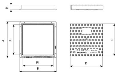
**Hidráulica D4 è progettato per sopportare un traffico medio.** Perfetto per essere installato su strade con un ADT di 1.000-20.000, specialmente per carreggiate stradali (incluso le vie pedonali), banchine e le aree di sosta per tutti i tipi di veicoli.
