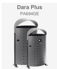
Portarifiuti realizzato in acciaio con trattamento Ferrus, un processo protettivo che garantisce un'ottima resistenza alla corrosione. Il trattamento consiste in una granigliatura per eliminare tutti i tipi di sporcizia ed ossidazioni, un bagno elettrolitico, seguito da una mano di primer epossidico ed una mano finale di vernice a polvere di poliestere di colore grigio antracite.
