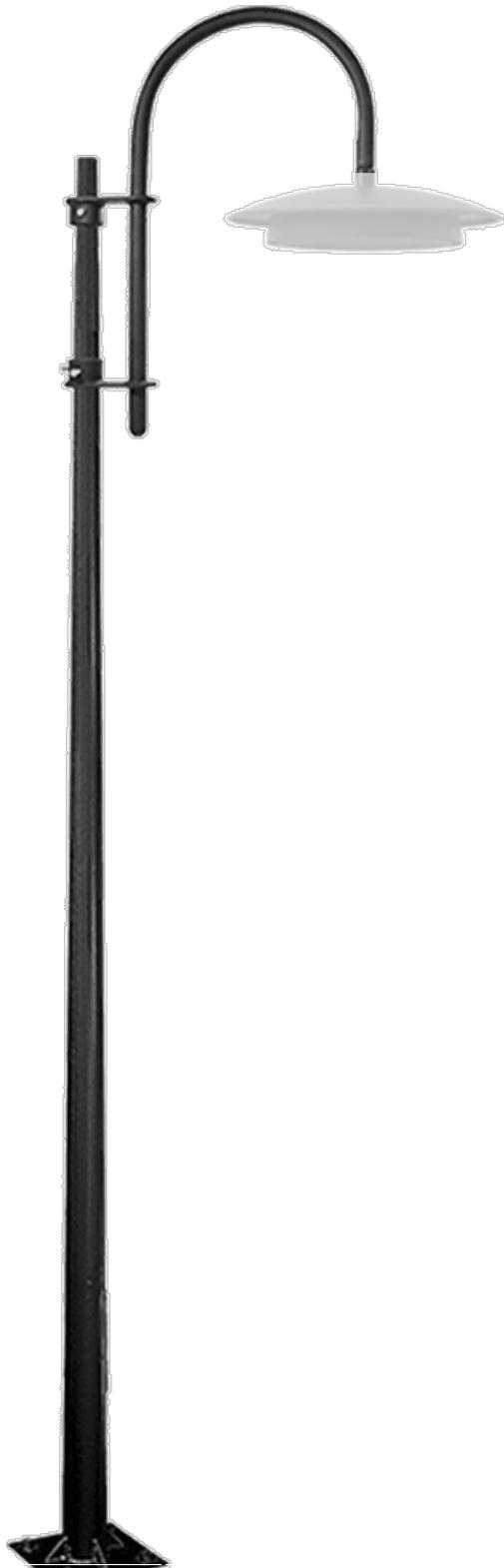
Palo realizzato in acciaio S-235-JR galvanizzato con primer antiruggine e finitura nera microtesturizzata. Spessore (base, palo): 3 mm. Fissaggio speciale 3 x M10 a 120°.
