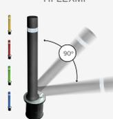
Dissuasore realizzato in poliuretano flessibile di colore nero (optional in rosso, verde, giallo o blu), resistente ai raggi UV, con fascia riflettente. Viene prodotto nella variante fissa od estraibile con basi in poliuretano o acciaio inox. Anche nella versione con piastra da avvitare. Supera una flessione di 1500 cicli a 45° e 50 cicli a 90°, senza danni. Classificazione "E" di comportamento al fuoco, secondo la norma UNE-EN 13501-1: 2007 + A1: 2010.
