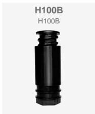
Dissuasore realizzato in polietilene compatto ad alta e bassa densità. Il nucleo centrale in gomma riciclata offre un'alta resistenza agli impatti. Con fascia riflettente nella parte superiore ed inferiore. Alta resistenza alle intemperie. Non si ossida né assorbe lo sporco. Eccellente resistenza ai raggi UV. Anti-graffiti e facile da pulire. Finitura opaca, colore antracite.
