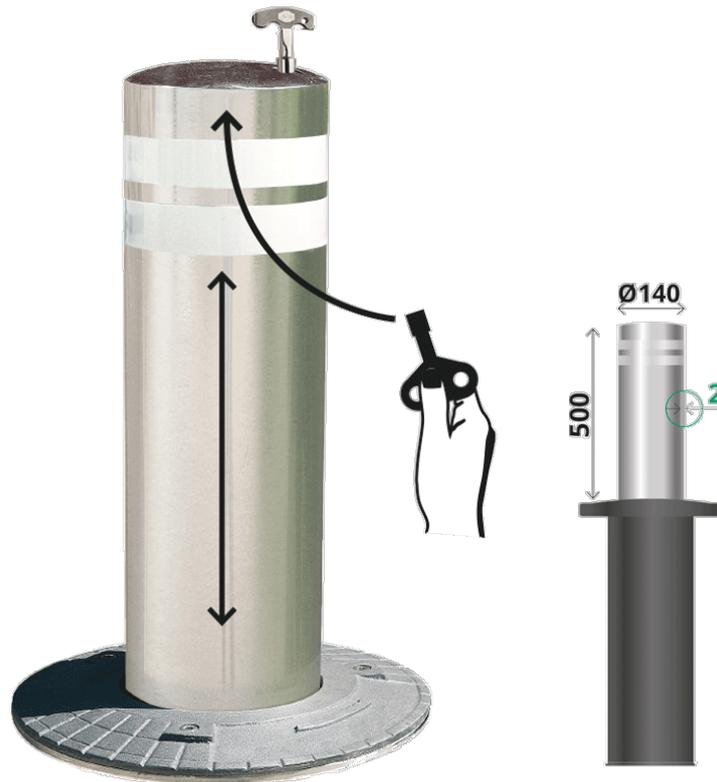
Il dissuasore Telescopica si distingue per essere semplice, pratico e di facile utilizzo. È un dissuasore a scomparsa con base ad incasso in acciaio inox che presenta 2 fasce rifrangenti bianche, ha un anello di finitura alla base in ghisa antiscivolo, si alza automaticamente e si abbassa manualmente grazie alla chiave con testa triangolare.
