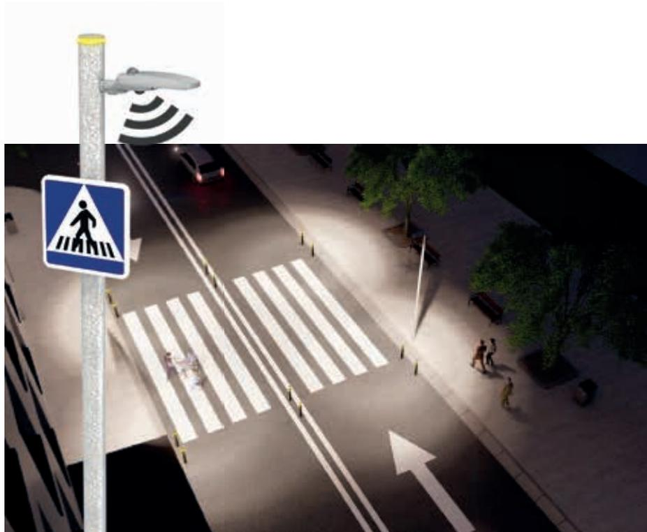
LES CAPTEURS DE MOUVEMENT DU POINT LUMINEUX ZÉBRÉ DÉTERMINENT L'ÉCLAIRAGE AU MOMENT DE L'UTILISATION
