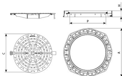
Hexa R est conçu pour supporter un trafic moyen. Idéal pour installation sur voies ayant un TMJ de 1.000 - 20.000, notamment sur chaussées, accotements stabilisés et aires de stationnement pour tout type de véhicule.
