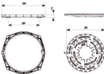
Innova C2 est conçu pour supporter un trafic modéré. Idéal pour installation sur voies ayant un TMJ de 500 à 1.000, notamment sur accotements et caniveaux.
