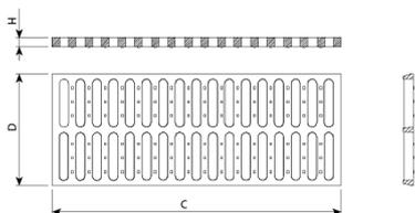
Mecalinea D4 est conçue pour supporter un trafic moyen. Idéale pour installation sur voies ayant un TMJ de 1.000 - 20.000, notamment sur chaussées, accotements stabilisés et aires de stationnement pour tout type de véhicule.
