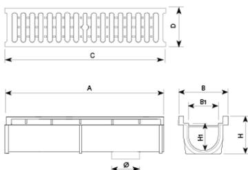
Caniveau + Mecalinea D4 conçu pour supporter un trafic moyen. Idéal pour installation sur voies ayant un TMJ de 1.000 à 20.000, notamment sur chaussées, accotements stabilisés et aires de stationnement pour tout type de véhicule.
