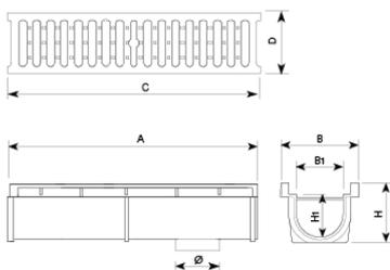
Caniveau + Mecalinea D4 conçu pour supporter un trafic moyen. Idéal pour installation sur voies ayant un TMJ de 1.000 à 20.000, notamment sur chaussées, accotements stabilisés et aires de stationnement pour tout type de véhicule.
