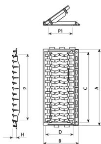
Onda est conçue pour supporter un trafic modéré. Idéale pour installation sur voies ayant un TMJ de 500 à 1.000, notamment sur accotements et caniveaux.
