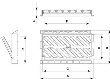
Delta est conçue pour supporter un trafic modéré. Idéale pour installation sur voies ayant un TMJ de 500 à 1.000, notamment sur accotements et caniveaux.
