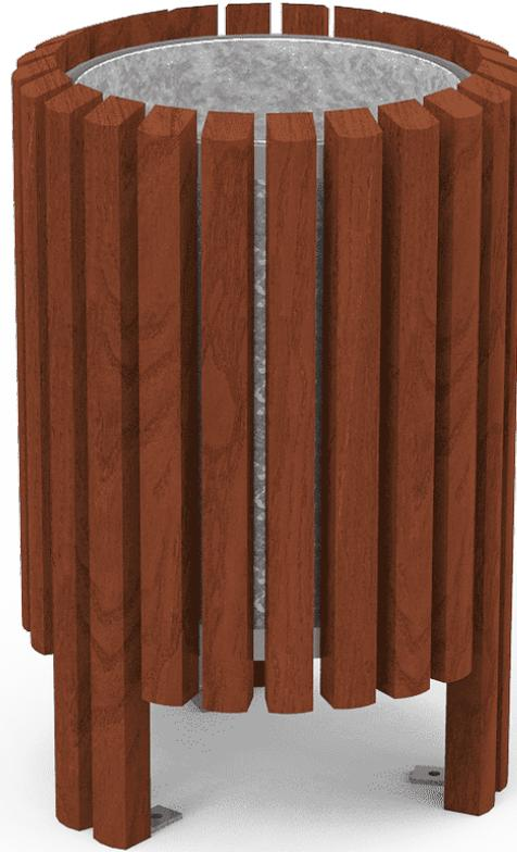
Corbeille avec structure intérieure métallique et extérieur avec vingt-quatre lattes en bois tropical de section 40 x 35 mm traité avec Lignus, protecteur fongicide, insecticide et hydrofuge. Finition teinte acajou. Seau intérieur en acier galvanisé. Ancrage recommandé : au moyen de trois boulons à expansion M8 en fonction de la surface et du projet.
