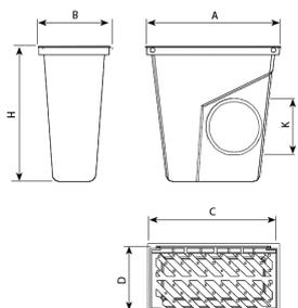
Imbornal sifónico DELTA, diseñado para soportar un tráfico con una IMD de 500 a 1.000, especialmente en arcenes y cunetas.
