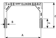
Stufe aus 12 mm Stahlstäben, mit Polypropylen überzogen um Korrosion zu verhindern. Säurebeständig. Die Stufe wird gemäß EN 13101 gefertigt. Montage: die Stufe 85mm in den Schacht einfügen. Empfohlener Abstand zwischen Stufen: 330mm. Seitenflügel für erhöhte Sicherheit und rutschfeste Oberfläche
