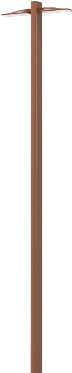
Mast aus gewalztem Stahl, rechteckig 200mm x 100mm. Verfügbare Höhen von 4m bis 7m, kann ein oder zwei Mastarme angebracht werden (auf selber oder verschiedener Höhe). Robust und langlebig, sein klares und modernes Design passt sich an jede städtische Umgebung an. Integrierte LEDs BENITO-NOVATILU Module, Leistungen von 20W bis 120W, für jede Anwendung geeignet.
