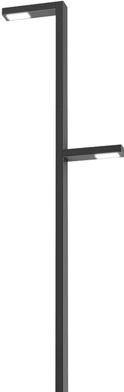
Mast aus gewalztem Stahl, rechteckig 200mm x 100mm. Verfügbare Höhen von 4m bis 7m, kann ein oder zwei Mastarme angebracht werden (auf selber oder verschiedener Höhe). Robust und langlebig, sein klares und modernes Design passt sich an jede städtische Umgebung an. Integrierte LEDs BENITO-NOVATILU Module, Leistungen von 20W bis 120W, für jede Anwendung geeignet.
