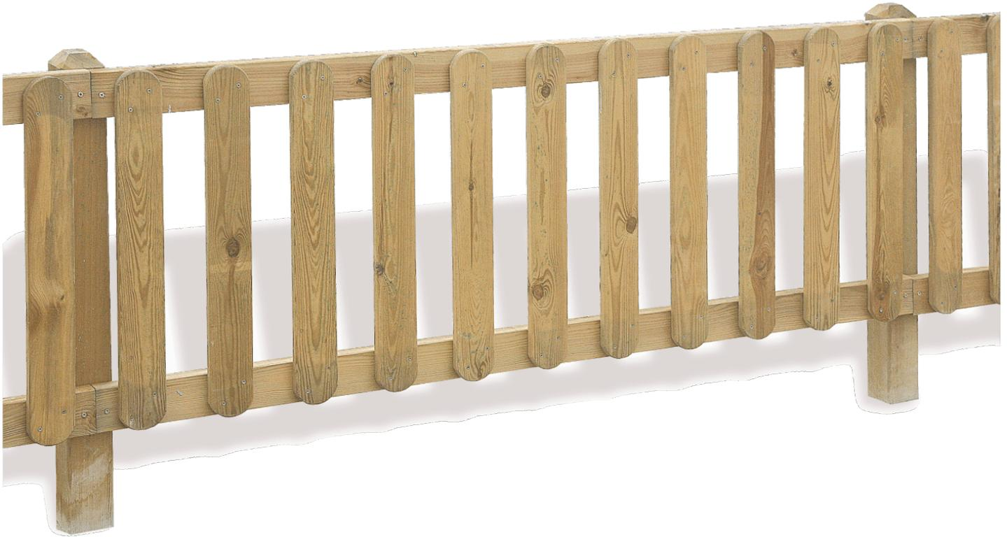
Valla fabricada en madera de pino con tratamiento autoclave a vacío-presión clase 4 contra la carcoma, termitas e insectos. Postes verticales de 1170 x 90 mm. Lamas con cantos redondeados.
