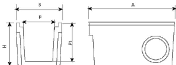
Canal HRM + Tango D4 diseñada para soportar un tráfico medio. Perfecta para instalar en vías con una IMD de 1.000-20.000, especialmente Calzadas de carreteras (incluyendo calles peatonales), arcenes estabilizados y zonas de aparcamiento para todo tipo de vehículos.
