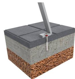
Anclaje recomendado: Mediante tornillos de anclaje INOX A4. HIT-V-M12x150 mm - WS 9350 12x160 mm. Taco químico. HILTI-HI-170 - Sika Anchorfix-1. No suministrados.
