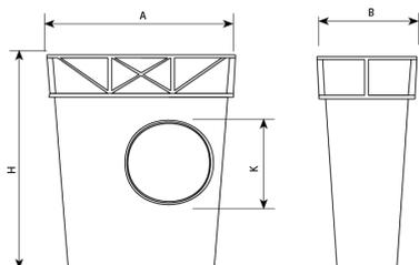
Óptimo está diseñado para realizar la función de encofrado para obtener la caja de imbornal con una instalación fácil, sencilla y económica.
