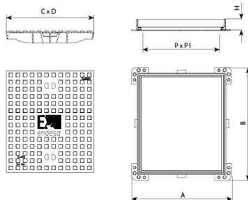
Endesa A1 está diseñada para soportar un tráfico medio. Perfecta para instalar en vías con una IMD de 1.000-20.000, especialmente calzadas de carreteras (incluyendo calles peatonales), arcenes estabilizados y zonas de aparcamiento para todo tipo de vehículos.
